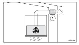
В режиме отвода воздуха шумоподавитель уменьшает внешние шумы, которые могут проникать на кухню через воздуховод (например, шум улицы). Для этого шумоподавитель должен располагаться перед выходным отверстием воздуховода ①, как можно ближе к нему.
