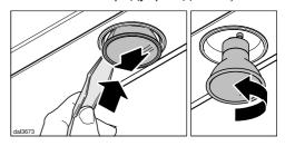
Вставьте прилагаемый шпатель в зазор между лампочкой и её патроном.
