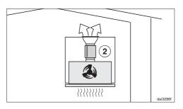
В режиме рециркуляции шумоподавитель устанавливается между выпускным патрубком и выпускной решёткой ②. Проверьте область встраивания.
