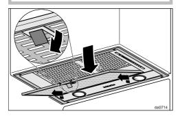
■ Ослабить фиксатор фильтра, наклонить фильтр примерно на 45° вниз, вывести из паза и снять.
