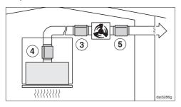
При выносном вентиляторе шумы вентилятора могут выводиться наружу и сводиться к минимуму на кухне. Если шумоподавитель устанавливается перед выносным вентилятором ③, на кухне уменьшаются шумы. Если воздуховод длинный, шумоподавитель должен устанавливаться на выпускном штуцере кухонной вытяжки ④.
